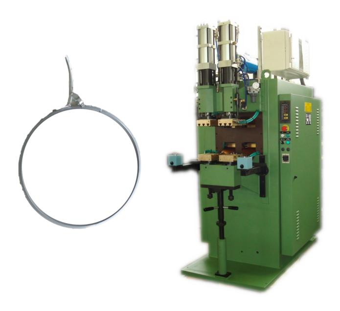
La saldatrice SDM60/P é una macchina manuale speciale che ha la particolarità di essere costituita essenzialmente da due saldatrici inserite in maniera organica in un'unica incastellatura.
